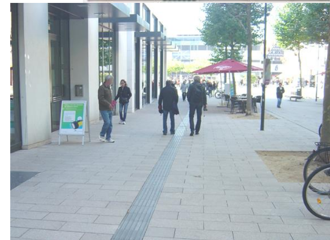
Fußgängerzone mit Blindenleitstreifen
